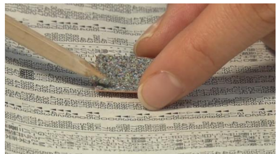
裏面に裏引き釉薬をのせます
